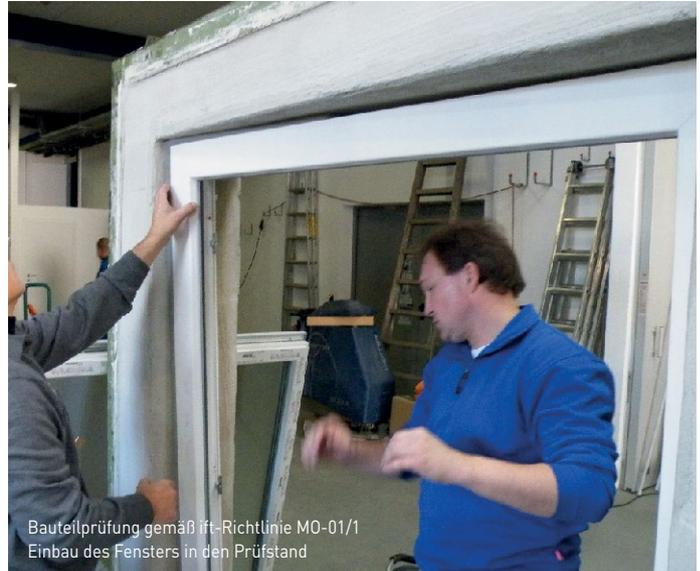
Bauteilprüfung gemäß ift-Richtlinie MO-01/1
