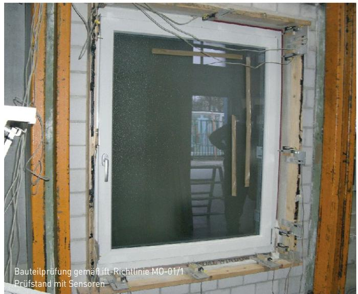
Bauteilprüfung gemäß ift-Richtlinie MO-01/1
